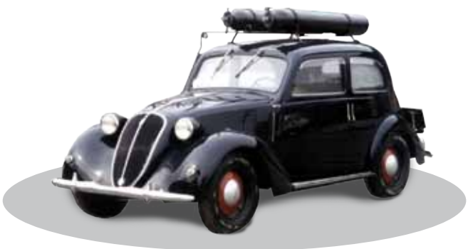
Ford N°75 mit Tartarini Gasanlage, 1939 umgerüstet
